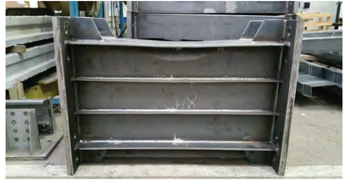
9. ábra: Beroppanási tönkremenetel a három bordával merevített gerinclemezű tartón, valamint a kísérleti és numerikus tönkremeneteli mód összehasonlítása (próbatest #2)
