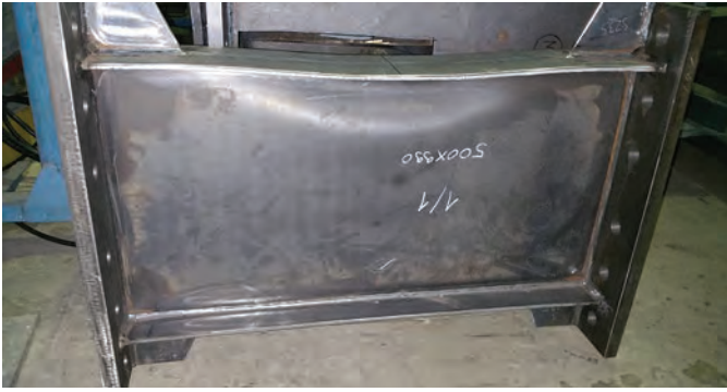
8. ábra: Beroppanási tönkremenetel a hosszbordával merevítetlen gerincű tartón, valamint a kísérleti és numerikus tönkremeneteli mód összehasonlítása (próbatest #1)
