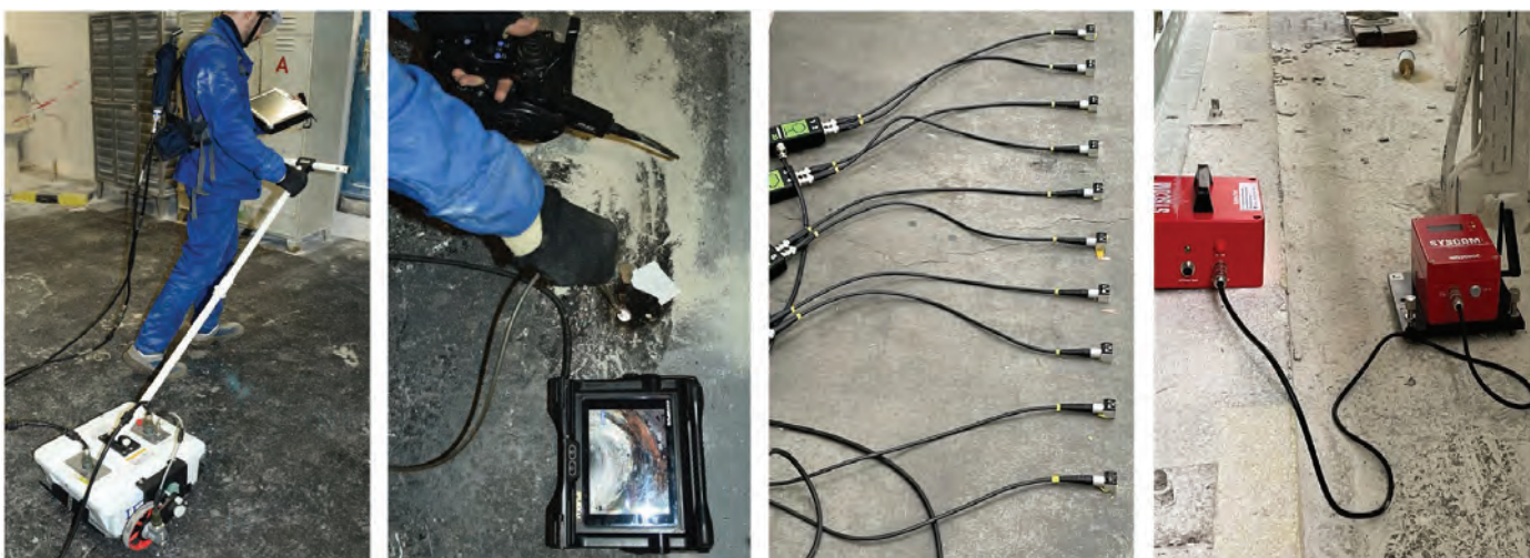
2. ábra: Ipari épület roncsolásmentes diagnosztikai és monitoring vizsgálata. A képen látható eszközök balról jobbra: georadar, videoendoszkóp, szonikus tomográf, rezgésmérő szenzor
