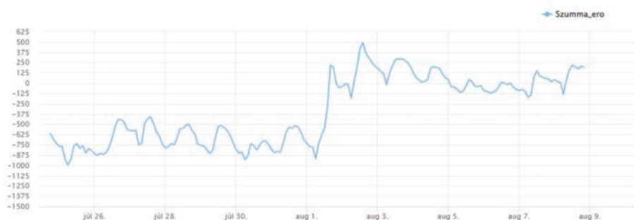
2. ábra: Járom „szumma erő” – aug.1.: Kalocsa Part 13 fenéklemez betonozása
