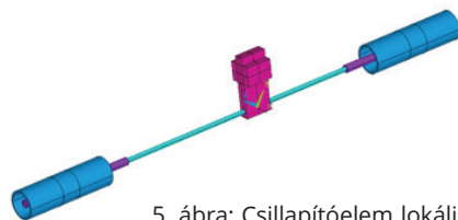
5. ábra: Csillapítóelem lokális numerikus modellje – 3D nézet.
