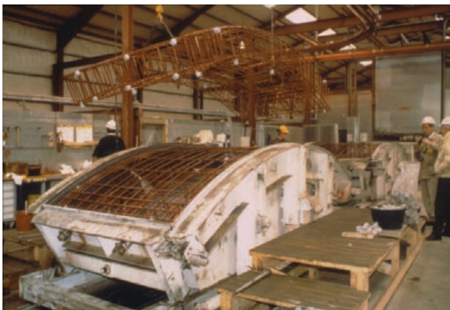
8. ábra Storebaelt-alagút vasbeton túbbingjei
